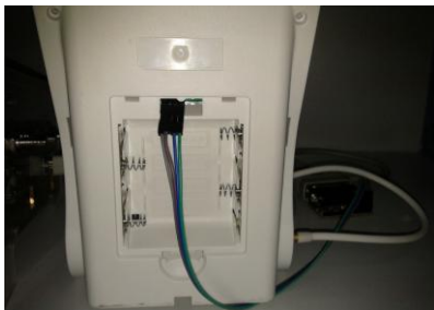
数据线插入 PCBA 板上标定位置上
