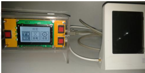
数据线插入 PCBA 板上标定位置上
